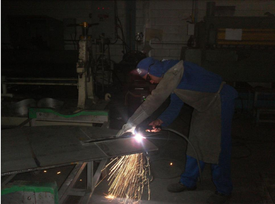
FIGURA 03 - Corte de amostra com plasma
