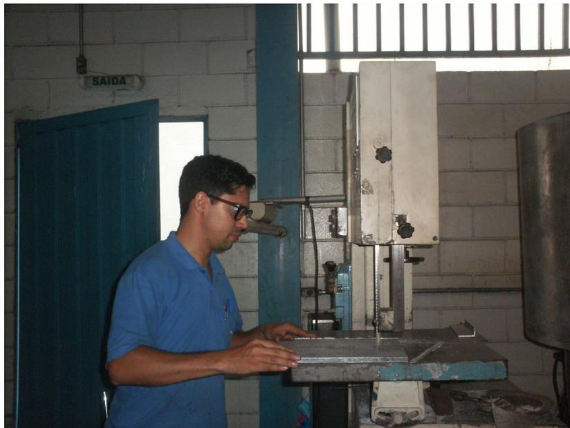
FIGURA 4 – Corte da zona termicamente afetada na chapa pelo corte a plasma
