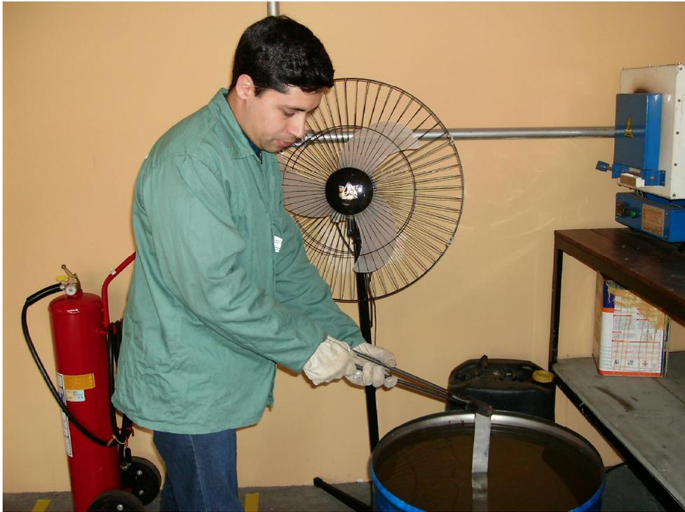
FIGURA 13 – Resfriamento rápido em água
