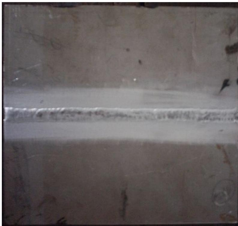
FIGURA 8 – Chapa soldada pelo processo TIG
