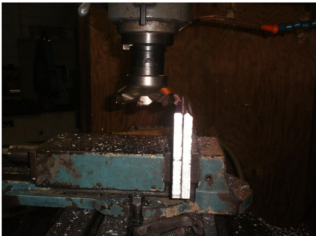
FIGURA 5 – Usinagem dos chanfros
