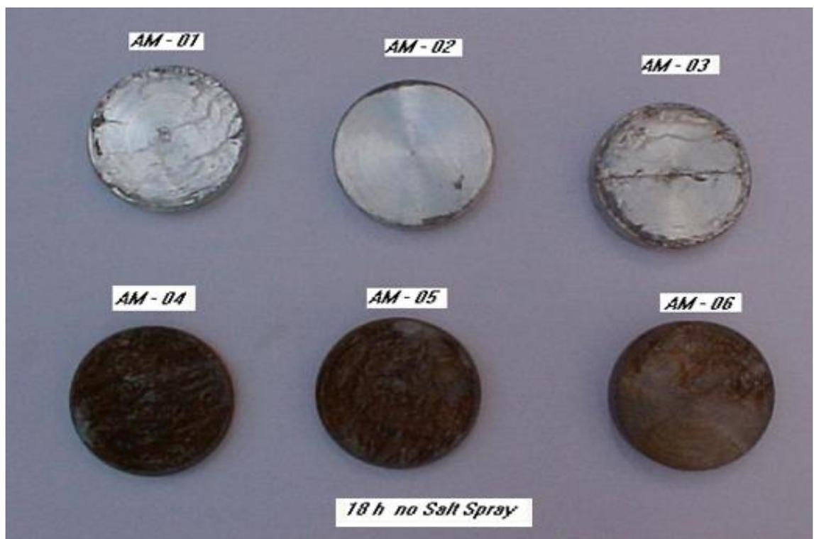
Figura 5 – Amostras após 18h no *Salt Spray*
