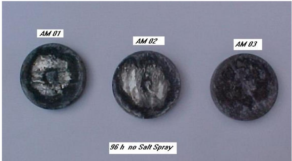
Figura 6 – Amostras zincadas após 96 horas no Salt Spray
