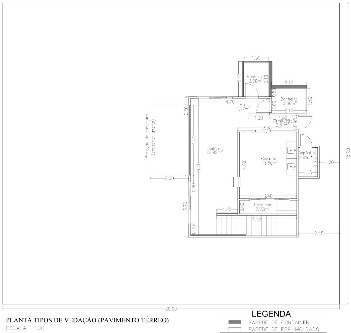
Figura 35: Planta de tipos de vedação (térreo)
