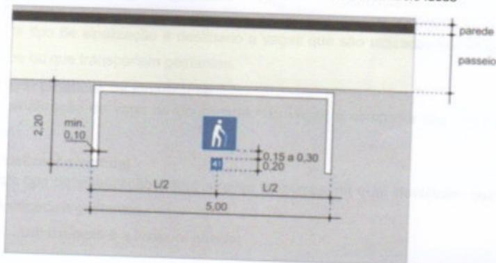
**Imagem 43:** aplicação com o pavimento da vaga pintado em azul com o respectivo detalhe de locação do número e símbolo
