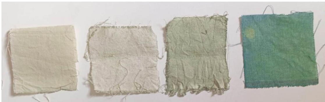
Figura 48: Resultado dos tingimentos em algodão, respectivamente, utilizando clorofila.
