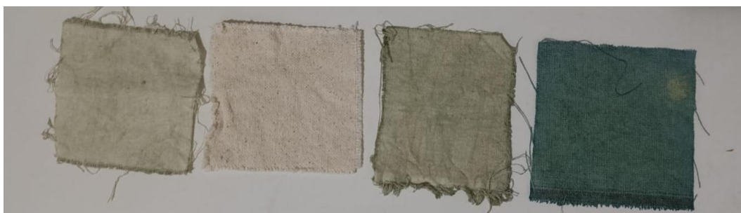
Figura 56: Resultado do teste de aderência do algodão, tingido com Clorofila.
