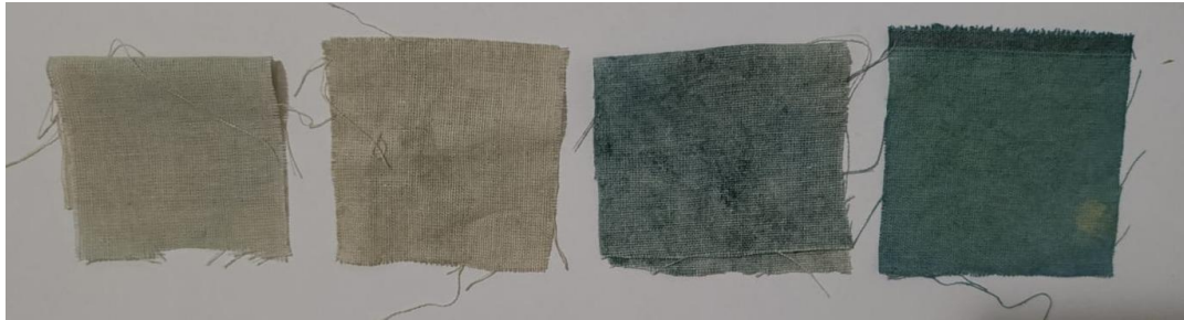
Figura 57: Resultado do teste de aderência do linho, tingido com Clorofila.
