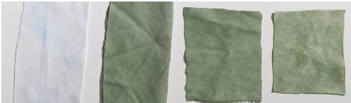
Figura 51: Resultado dos tingimentos em elastano, respectivamente, utilizando clorofila.
