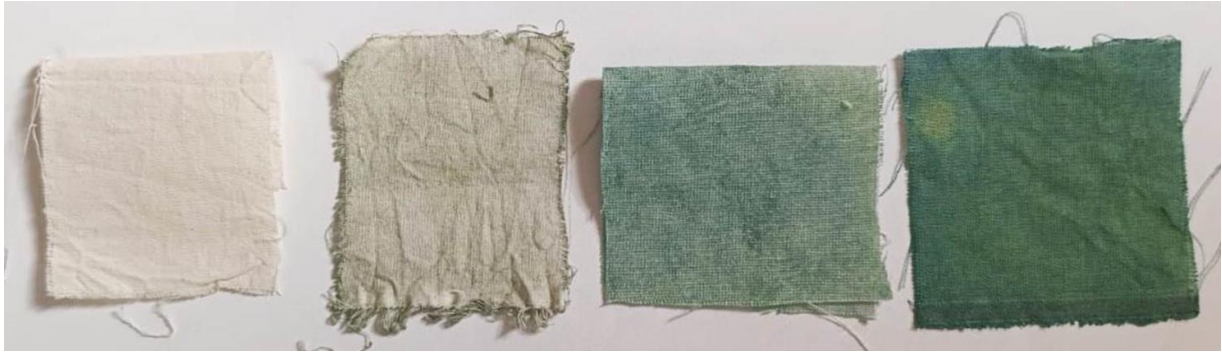
Figura 49: Resultado dos tingimentos em linho, respectivamente, utilizando clorofila.
