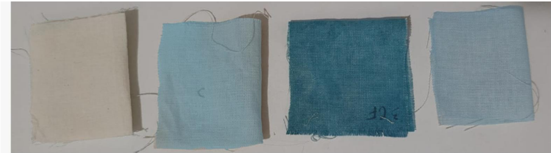
Figura 53: Resultado do teste de aderência do linho, tingido com Ficobilina.
