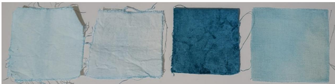
Figura 52: Resultado do teste de aderência do algodão, tingido com Ficobilina.
