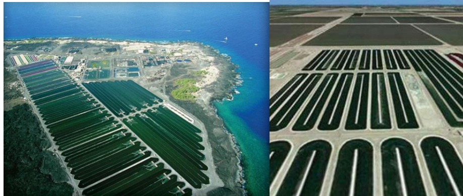
Figuras 2 e 3: Sistema de cultivo de microalgas aberto.
