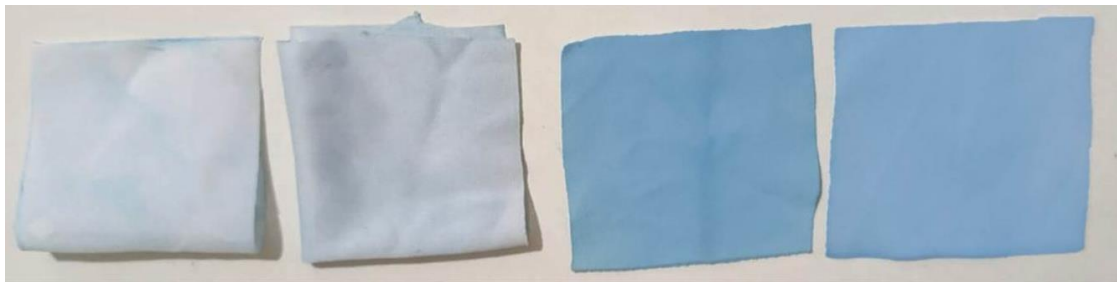
Figura 54: Resultado do teste de aderência do poliéster, tingido com Ficobilina.
