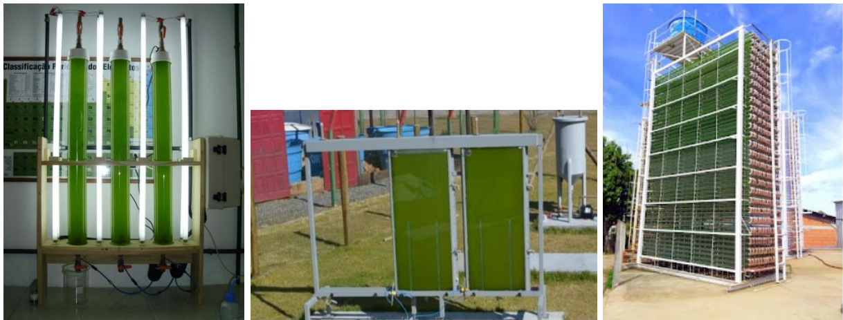
Figuras 4 a 6: Respectivamente, fotobiorreatores tubulares, planos e verticais.
