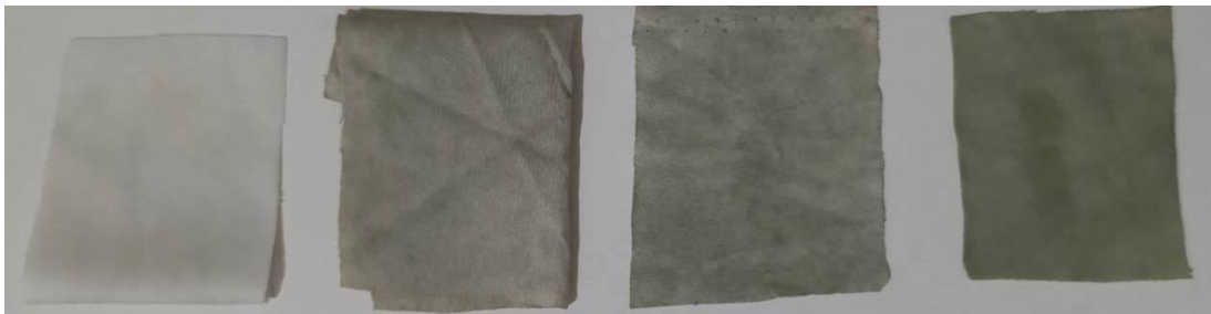
Figura 59: Resultado do teste de aderência do elastano, tingido com Clorofila.
