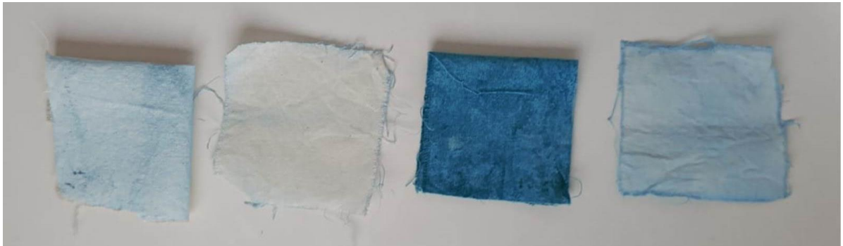
Figura 44: Resultado dos tingimentos em algodão, respectivamente, utilizando ficocianinas.
