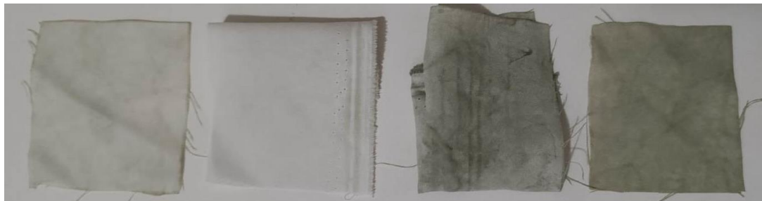
Figura 58: Resultado do teste de aderência do poliéster, tingido com Clorofila.
