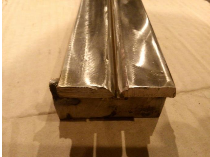
Figura 8. Metal base na posição em que foi realizada a soldagem
