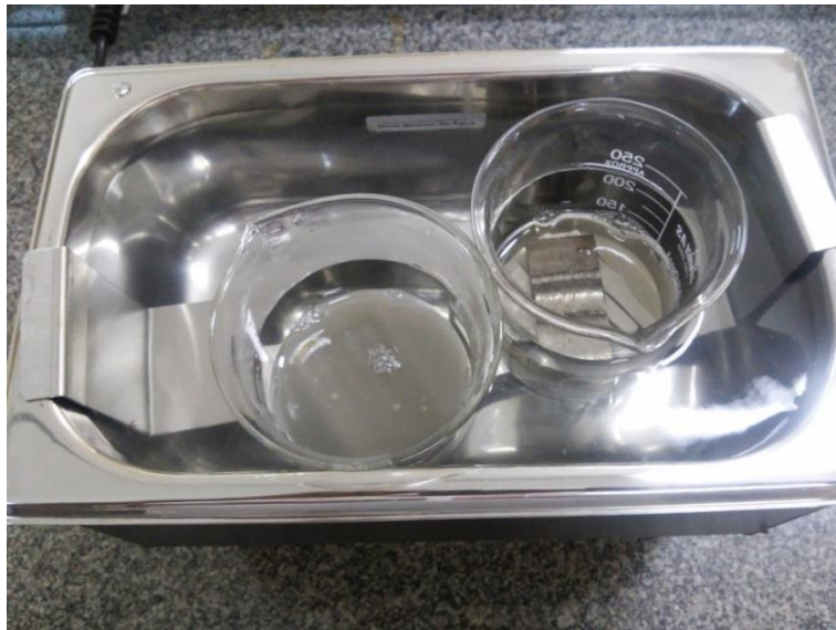
Figura 11. Limpeza das amostras por ultrassom
