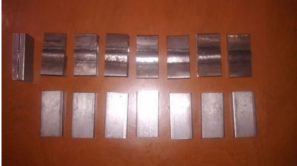
Figura 10. Corpos de prova soldados e sem solda
