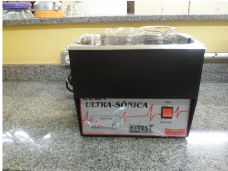
Figura 12. Cuba ultrassônica para limpeza das amostras
