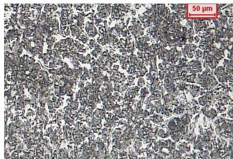
Figura 28: Região rica em carbonetos do tipo MC.
