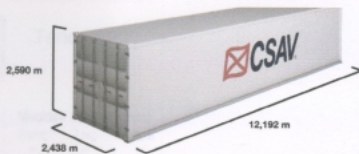
Figura 7: Dimensões do Container Reefer 40'
