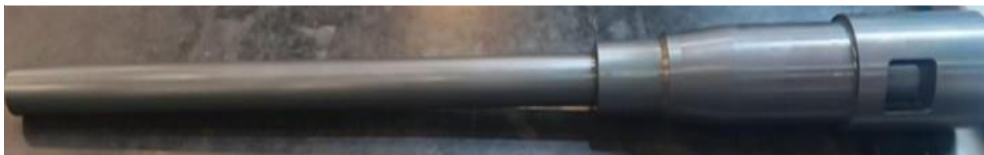
Figura 15-Postigo finalizado a usinagem
