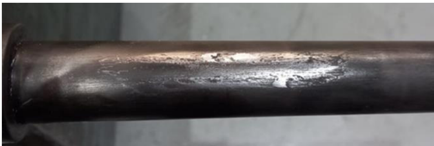
Figura 11-Postiço demonstrando erosão prematura
