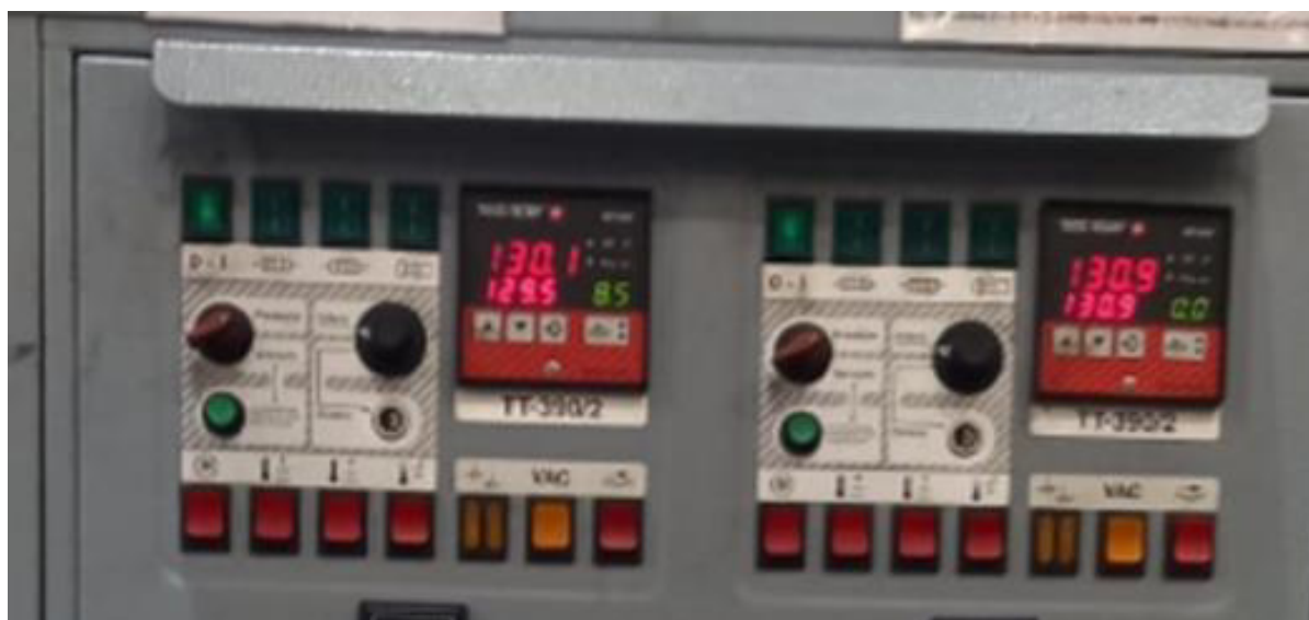
Figura 23-Controle de temperatura do molde
