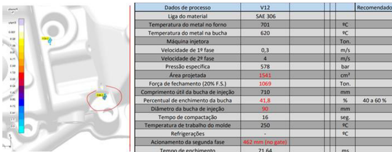
Figura 7-Simulação de injeção realizado por softwere específico
