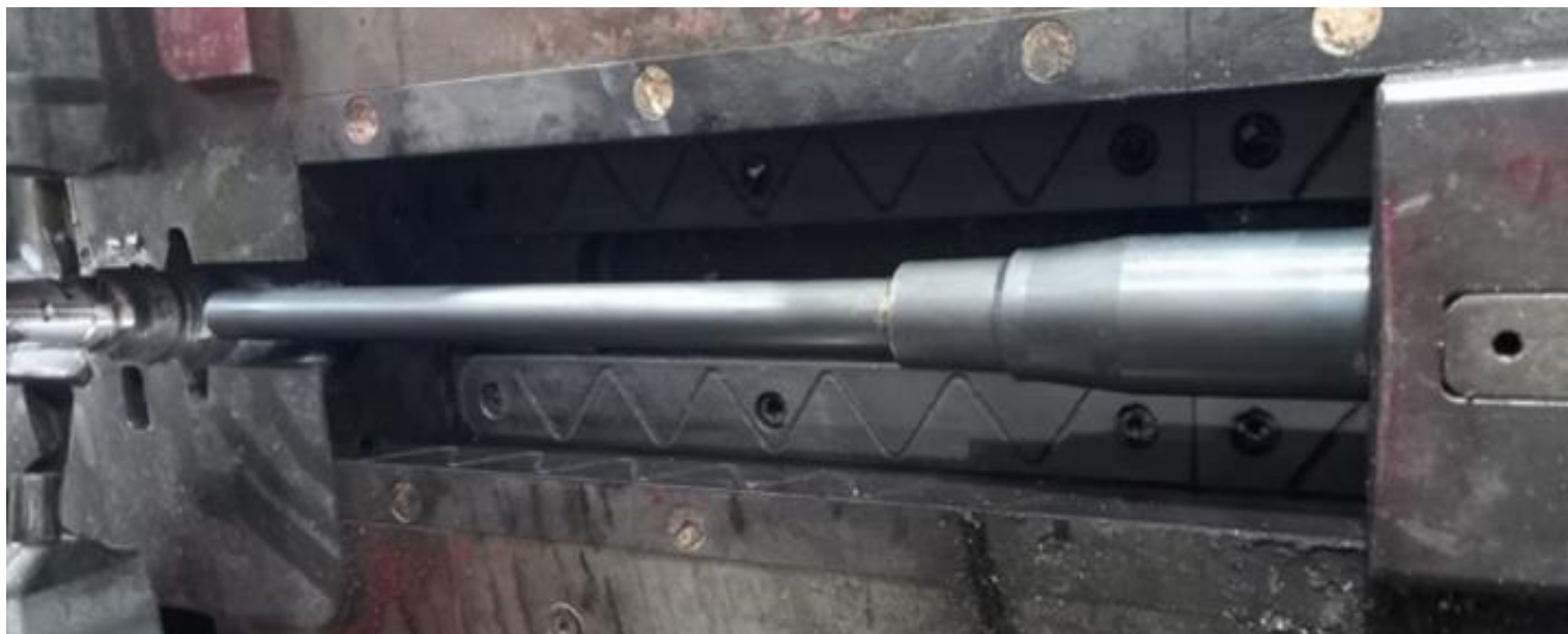
Figura 20-Montagem do postiço no molde
