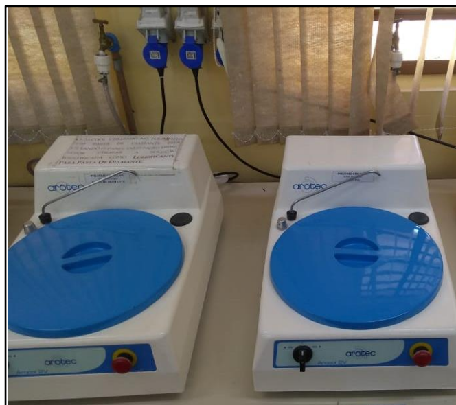
Figura 17 - Politriz circular; politriz da direita (pasta de diamante); politriz da esquerda (pasta de sílica)
