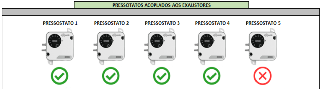
Figura 14 - Animação dos Pressostatos com falha.
