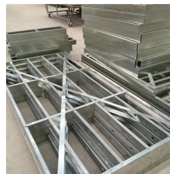
Figura 21: O processo de panelizado é feito todo na fábrica, formando os painéis pré fabricados. Fonte: Google 2024
