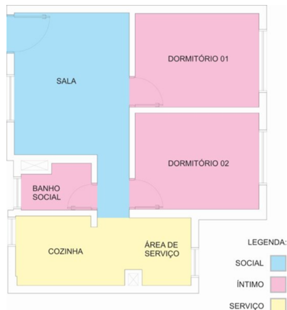
Figura 103: Planta baixa do 3º pavimento setorizada
