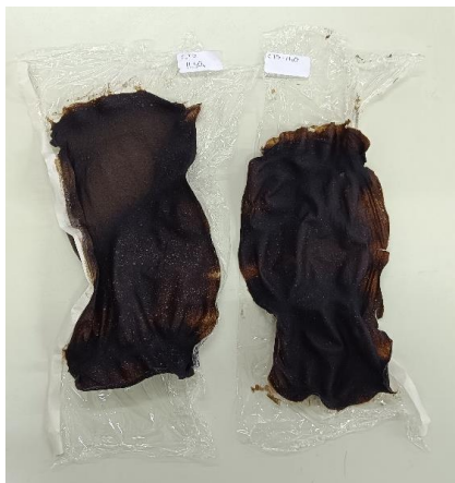
Figura 5. Bioplástico com Tratamento com ácido sulfúrico (CTB H 2 SO 4 ) a esquerda e com tratamento com água destilada (CTB H 2 O ) a direita.
