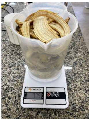
Figura 1. Pesagem das cascas de banana in natura (1); pesagem das cascas secas (2); pesagem da CTB (3).
