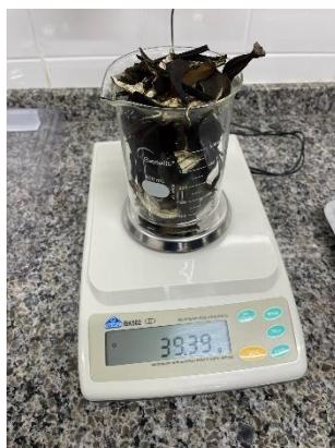
Figura 1. Pesagem das cascas de banana in natura (1); pesagem das cascas secas (2); pesagem da CTB (3).
