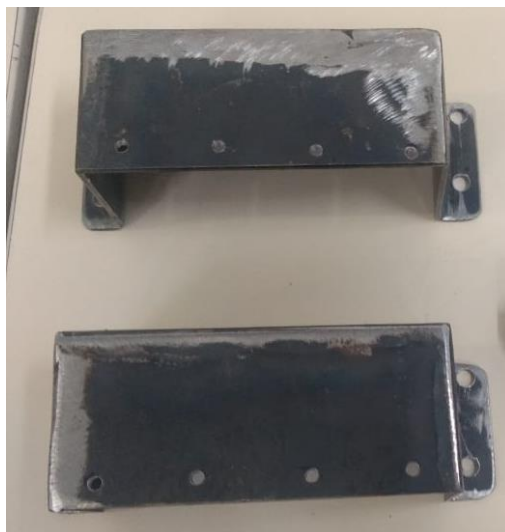
Figura 11 – Fabricação da caixa de fixação.
