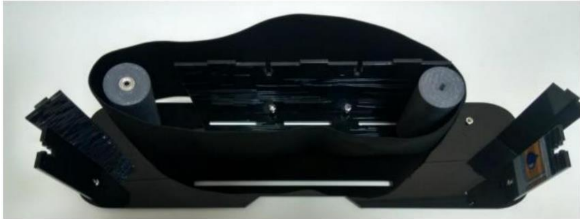
Figura 27 – Instalação do elemento transportador
