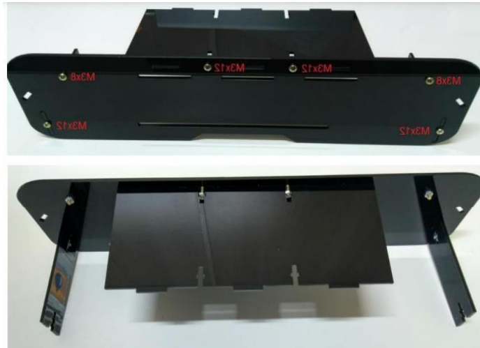
Figura 24 – Montagem da esteira
