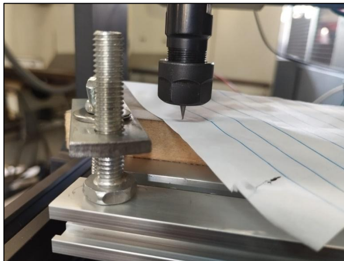
Figura 47 – Verificando altura da fresa na peça.
