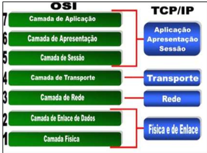
Figura 4 -- As 7 Camadas do modelo OSI
