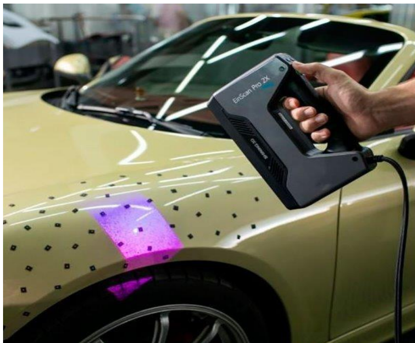
Anexo 5: Utilização do scanner 3D em indústria de automóveis. Fonte: UP3D (Link na seção referências)
