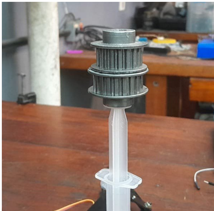
Figura 24 Foto tirada durante um Teste da força da seringa.
