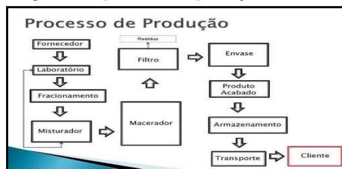
Figura 1. Fluxograma do processo de produção industrial do perfume
