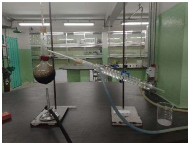
Figura 11. Processo de Hidrodestilação
