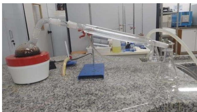
Figura 16. Montagem do sistema de extração
