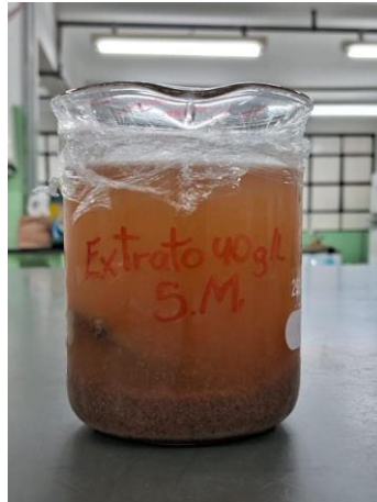
Figura 17. Solução de HCl com extrato de mamão de 400mg/L em 50mL (amostra 2).
