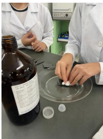
Figura 12. Limpeza do aço com acetona.
