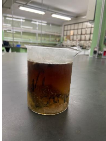
Figura 24. Solução de HCl com extrato de carqueja de 40g/L em 50mL (amostra 4).
