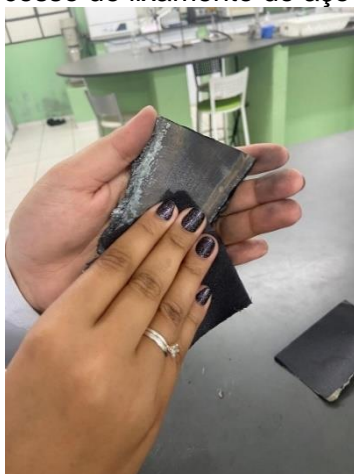
Figura 10. Processo de lixamento do aço carbono 1020.
