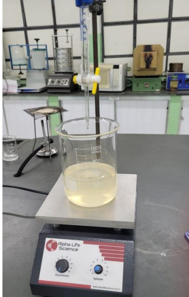
Figura 22. Sistema de gotejamento de etanol
