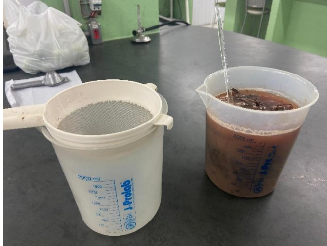
Figura 6. Solução de carbonato de cálcio e fibra de coco
