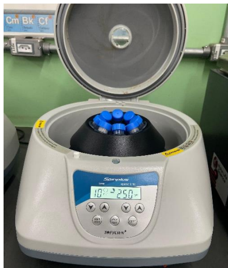
Figura 27. Processo de centrifugação da pectina no procedimento definitivo
