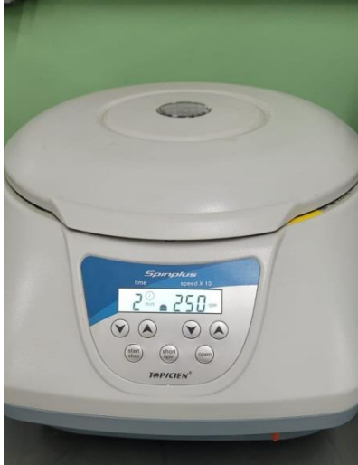
Figura 21. Processo de centrifugação da pectina
