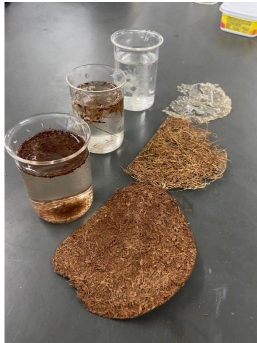
Figura 44. Resultado do teste de dissolução na água
