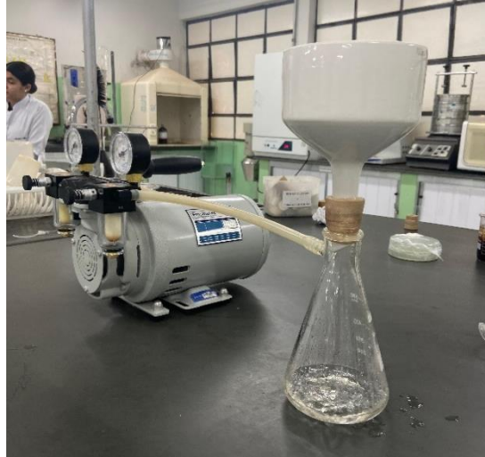
Figura 23. Filtração a vácuo da solução aquosa da pectina
