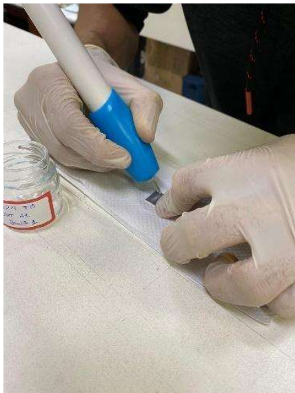
Figura 5 – Riscos nas chapas.
