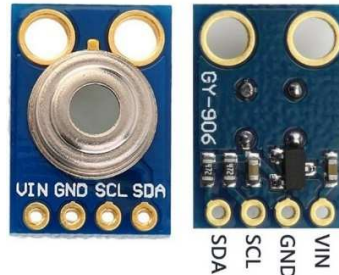
Figura 4 - Datasheet sensor infravermelho modelo mlx90614
