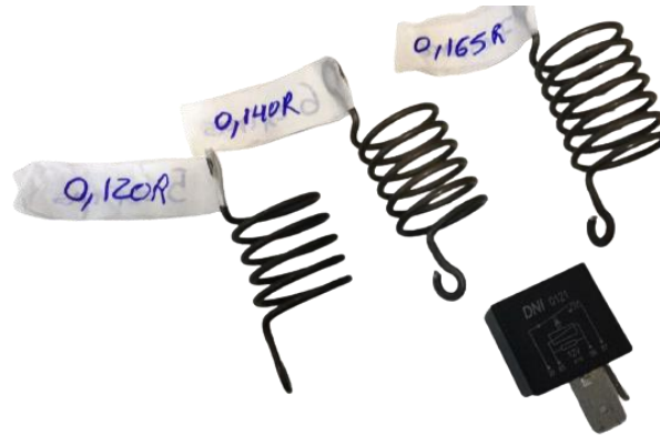
Figura 17 - Resistores de Descarga e Relé 70A
