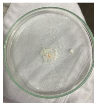
Figura 8: Foto tirada após secagem das micropartículas de PLA/PEG e cetoprofeno na primeira formulação.
