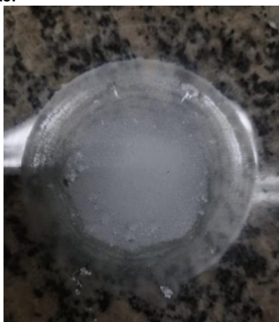
Figura 9: Foto tirada após secagem das micropartículas de PLA/PEG e cetoprofeno na segunda formulação.
