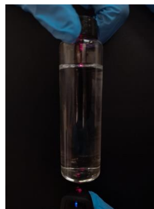
Figura 4: Feixe de luz não se propagando no meio da água destilada.
