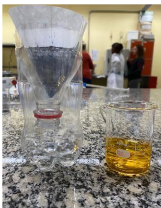
Figura 13. Filtro de garrafa PET com carvão ativado
