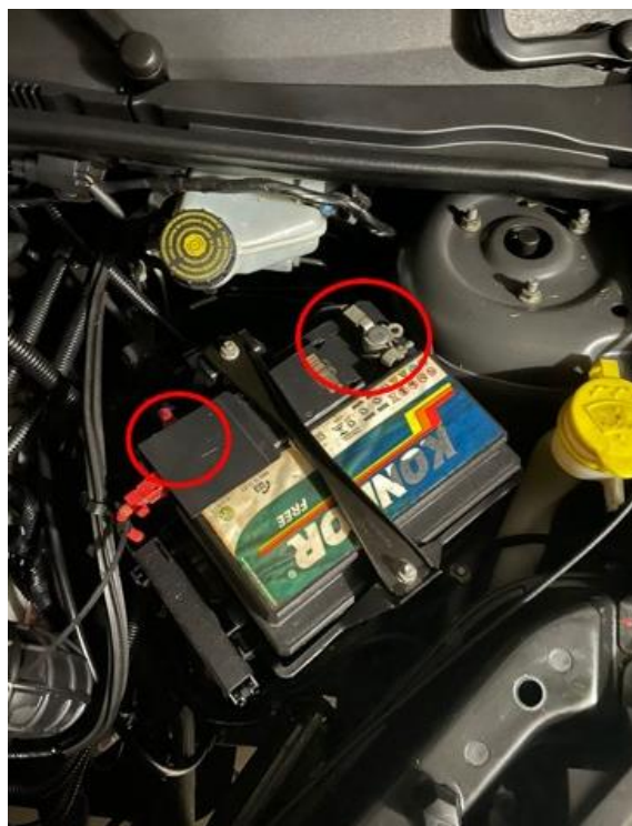
Figura 18 – Ponto de instalação sensor ACS758
