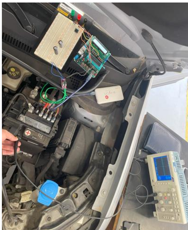
Figura 34 – Circuito do sistema em funcionamento
