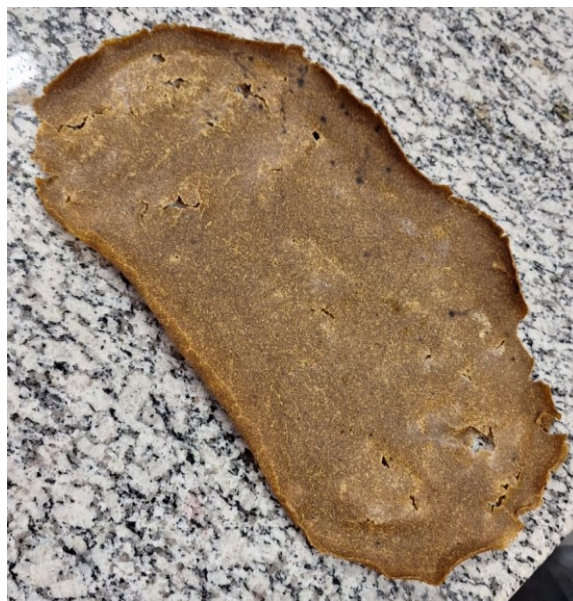
Figura 5 - Teste 1.1 do couro vegetal depois de seco.
