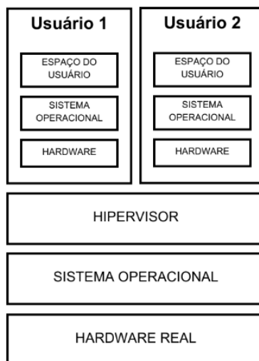
Figura 2 – Diagrama do modelo de virtualização baseado em hipervisor
