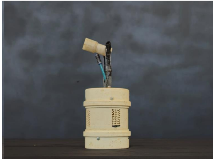
Figura 14: Cesto de PVC de diâmetro 150mm com bomba e suporte instalado.
