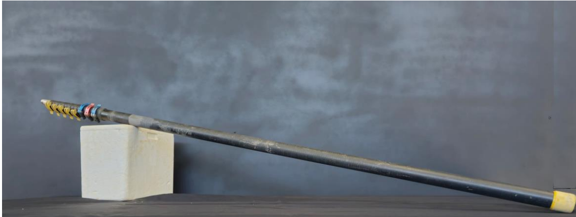
Figura 6: Haste telescópica em fibra de carbono alcance de 13m.
