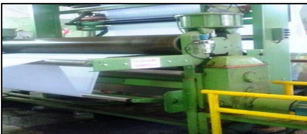
Figura 4: Foulard de Impregnação – Empresa Tintex Indústria Têxtil
