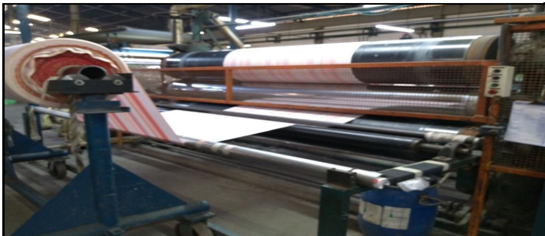
Figura 11: Entrada da Calandra – Empresa Tintex Indústria Têxtil
