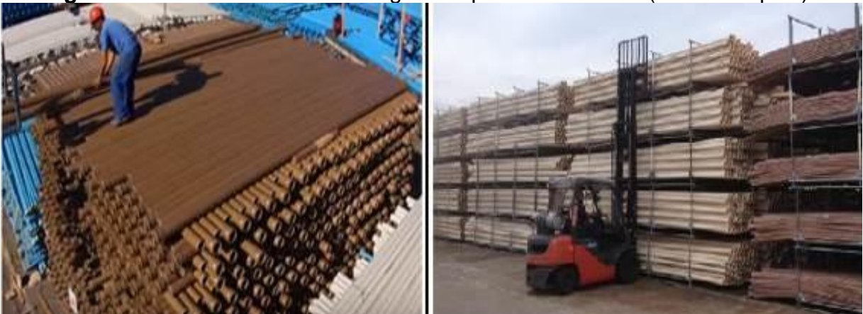
Figura 9 - Melhorias na armazenagem do produto acabado (antes x depois).
