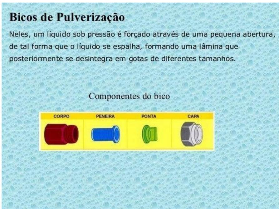
Figura 02. Fonte: Componentes do bico. [www.slidesharecdn.com/pulverização](http://www.slidesharecdn.com/pulverização)
