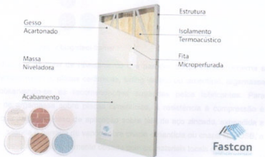
Figura 1 - Estrutura do Steel Frame
