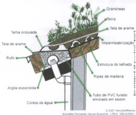
Figura 11- Camadas utilizadas na cobertura para captação de água
