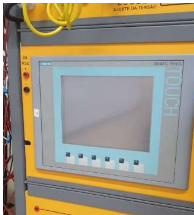
Figura 16: IHM Siemens Utilizado no Projeto FONTE: Arquivo Pessoal (2023).
