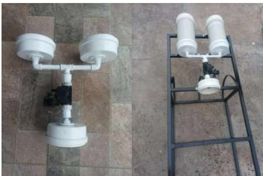
Figura 10: Tampa do Reservatório com a Válvula Solenoide FONTE: Arquivo Pessoal (2023).
