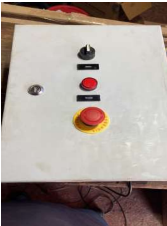
Figura 13: Botões e Lâmpada Instalados FONTE: Arquivo Pessoal (2023).
