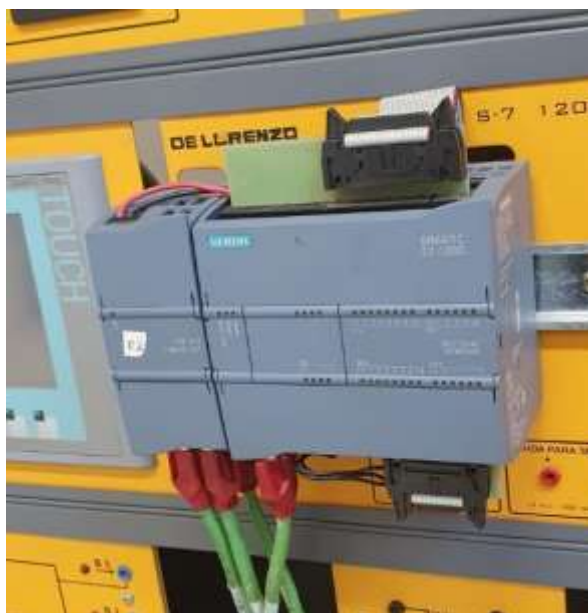
Figura 8: CLP siemens utilizado no Projeto FONTE: Arquivo Pessoal (2023).
