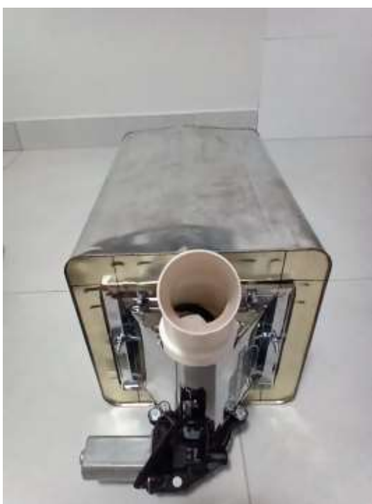
Figura 10: Motor Alimentador Fixado ao Reservatório de Alimento FONTE: Pessoal (2023).
