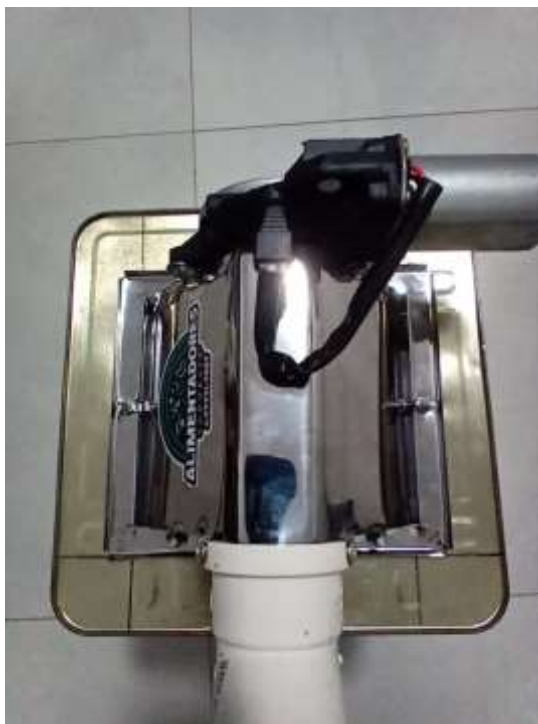
Figura 11: Motor Alimentador Fixado ao Reservatório de Alimento FONTE: Pessoal (2023)
