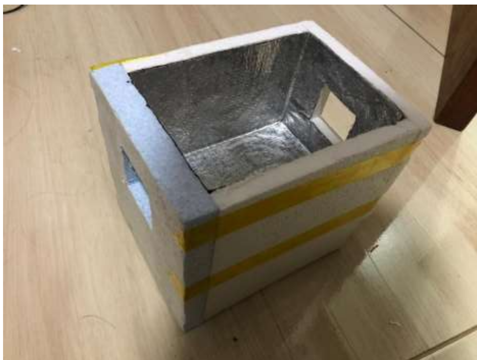
Figura 5: Caixa com Recortes Realizados e seu Interior Revestido com Fita Térmica FONTE: Arquivo pessoal (2023).
