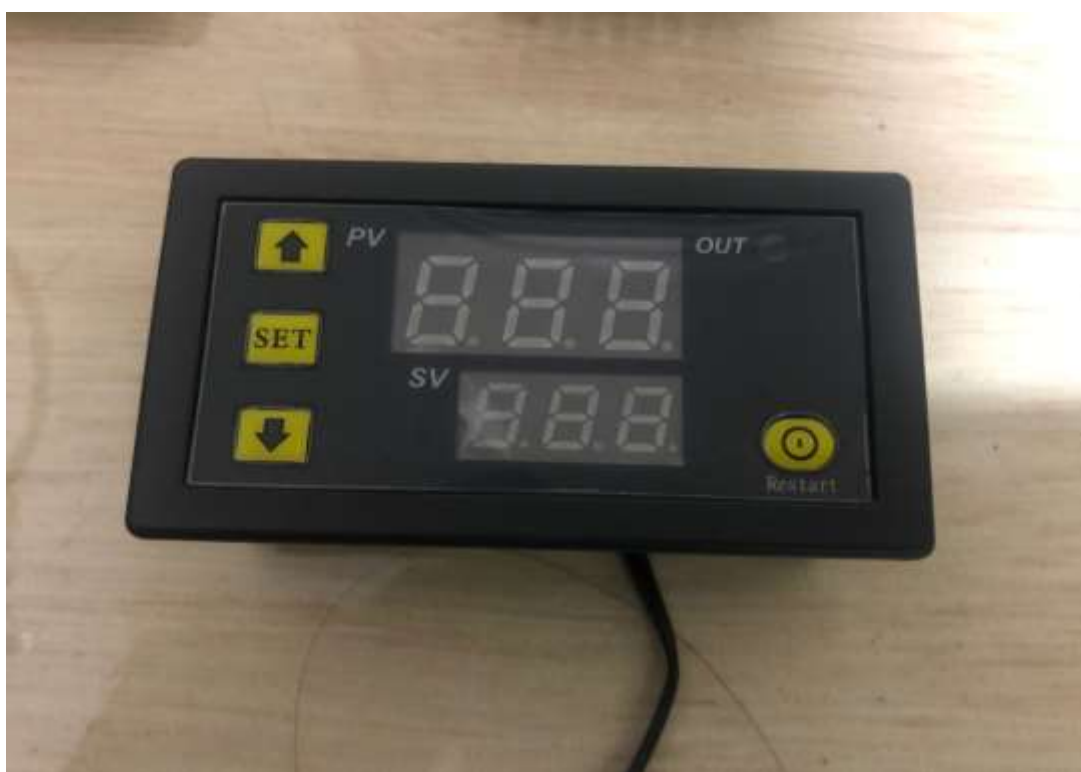
Figura 10: Controlador de Temperatura Digital Termostato 12V (Volt) FONTE: Arquivo pessoal (2023).
