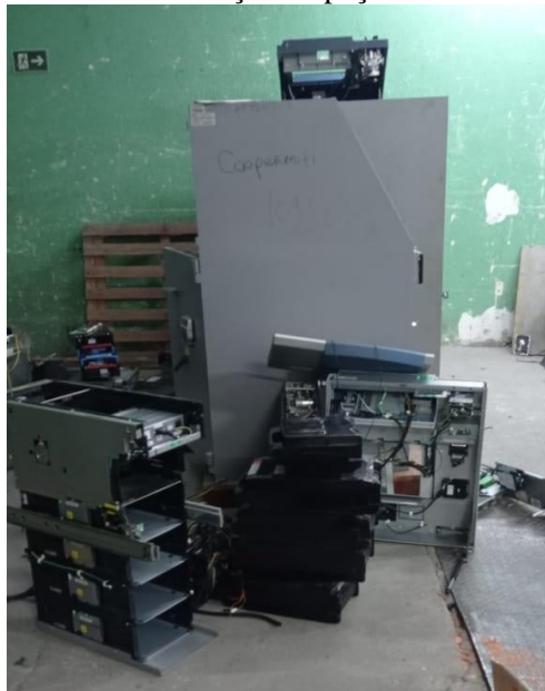
Figura 32: Descaracterização de peças do Caixa Eletrônico
