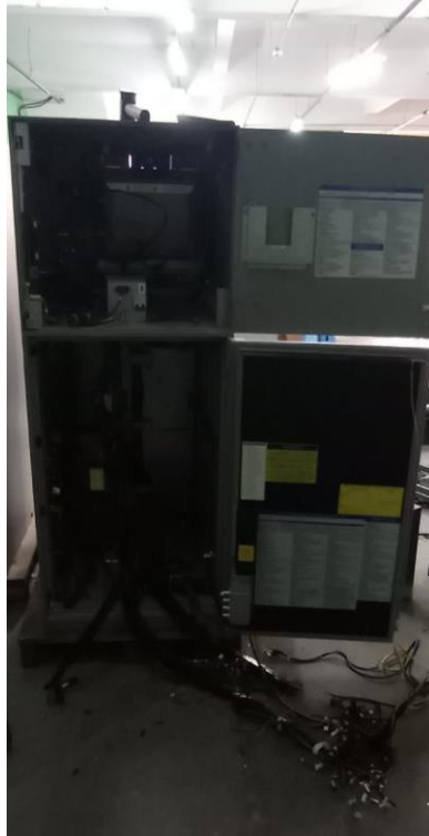
Figura 31: Descaracterização e desmontagem do Caixa Eletrônico
