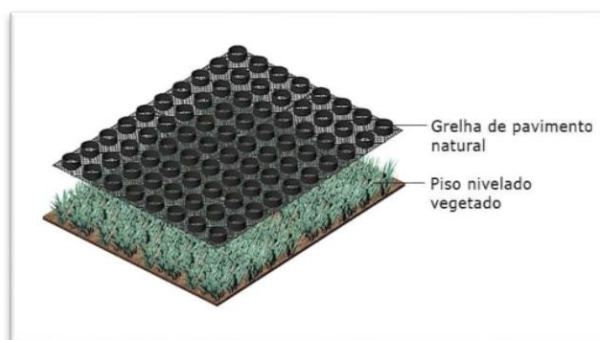
Figura 3 - Demonstração de instalação de ecopavimento de grama, fonte: Ecotelhado
