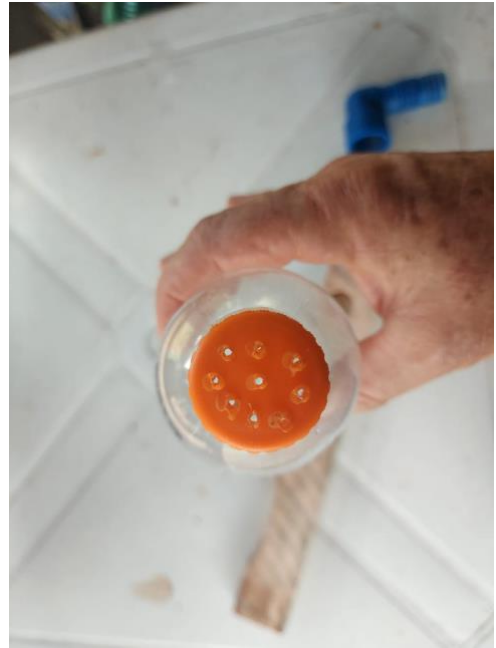
Figura 11: furos na tampa
