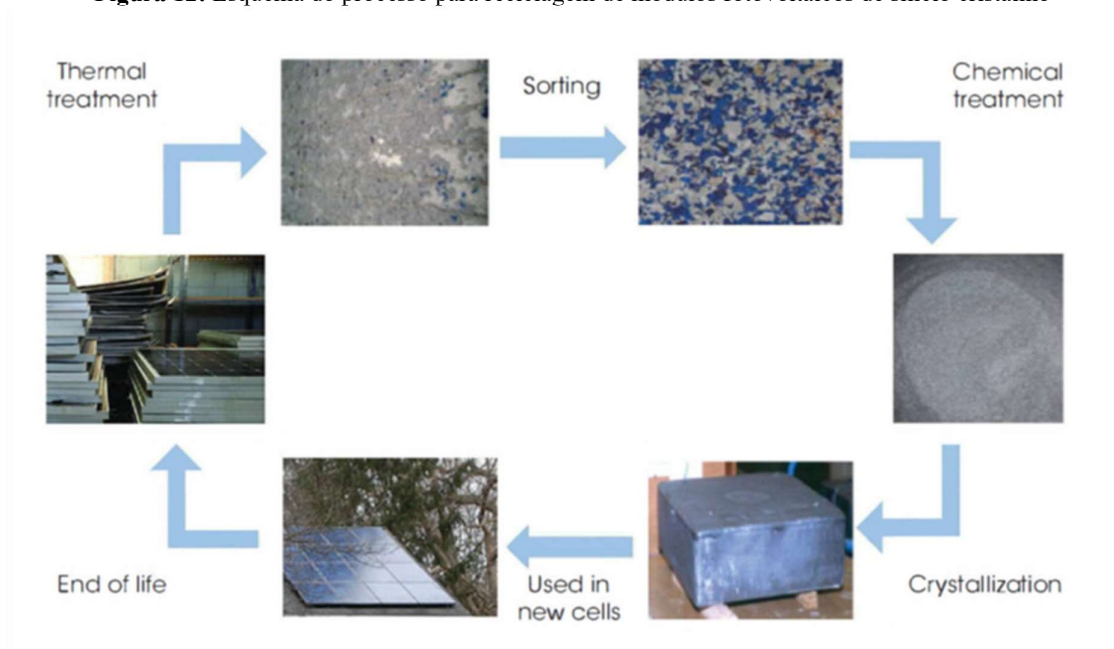
Figura 12: Esquema do processo para reciclagem de módulos fotovoltaicos de silício cristalino
