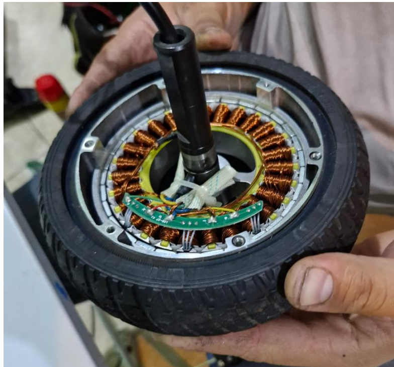
Figura 3: Hub Motor (motor brushless e roda)
