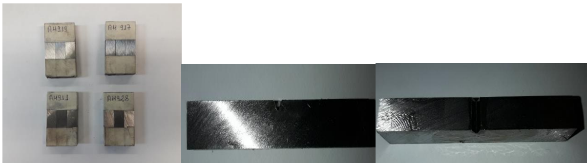
Figura 23 - Corpos de prova charpy conforme ASTM E23
