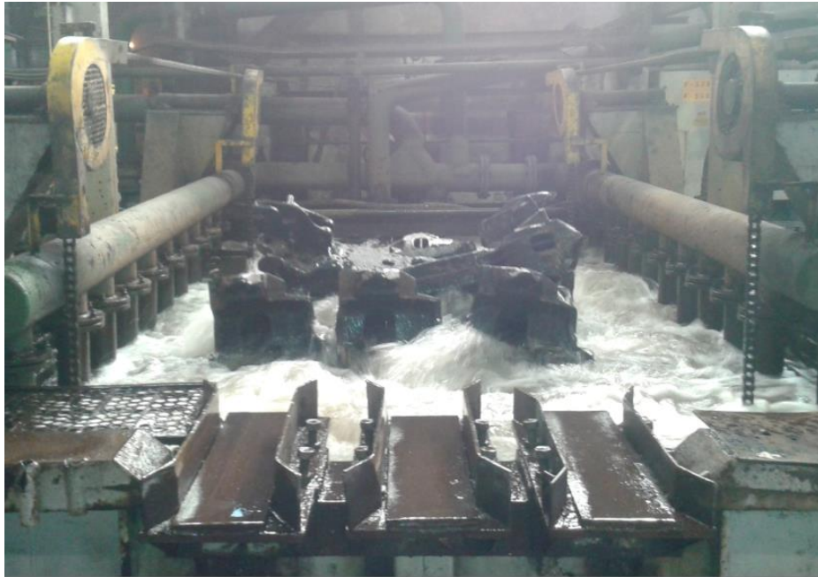
Figura 18 - Retirada da carga do tanque de resfriamento
