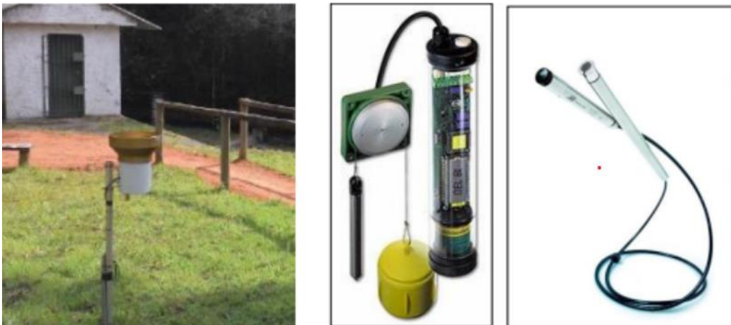
Figura 20. Pluviômetro (à esquerda) e os dois tipos de sensores de altura da água: bóia e contrapeso e transdutor de pressão, com datalogger (à direita).
