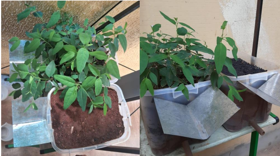
Figura 15. Camada superficial do pasto e captadores da água superficial instalados
