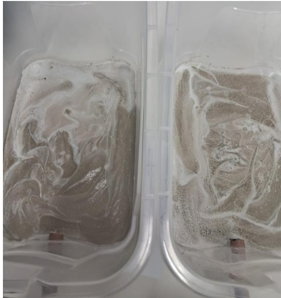
Figura 8. Massa impermeabilizante (seca) na base das caixas.
