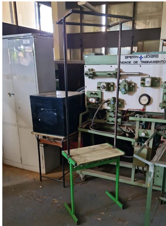
Figura 4. Estrutura de ferro do simulador de chuva concluída.
