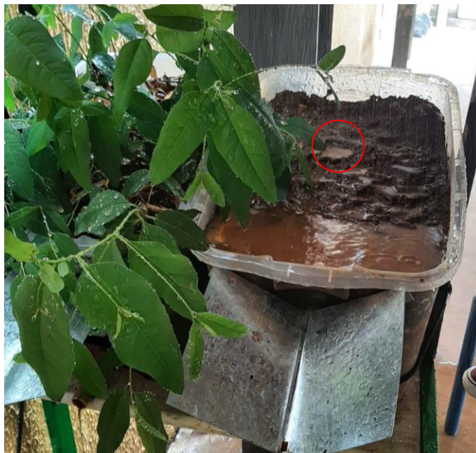
Figura 42. Evidência de erosão.
