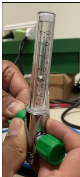
Figura 5.4 - Montagem para controle da válvula - Conexão com o fluxômetro
