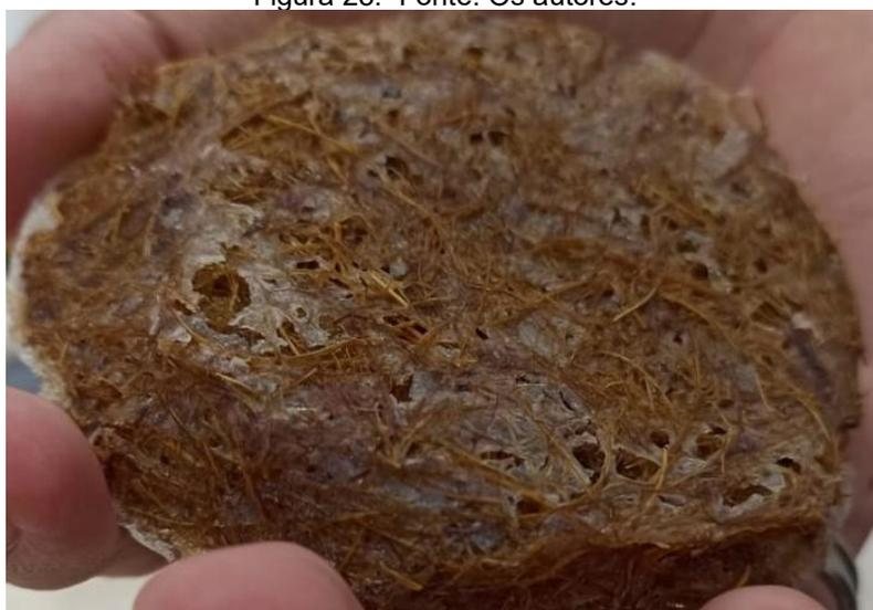
O procedimento foi realizado novamente, entretanto, dessa vez, com 16 receitas, para cobrir uma forma de alumínio retangular de 21cm de comprimento, aproximadamente. A principal diferença desse processo para o anterior é que as fibras foram depositadas após o bioplástico ter sido despejado na forma de alumínio. Porém, o resultado não foi agradável e a amostra ficou desregular e quebradiça, pois o plástico filme que forrou a forma não ficou estável nas extremidades. Ademais, o líquido do
