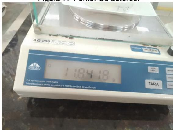
Com o intuito de analisar a sua decomposição, levou-se as amostras prontas e colocou em meios para a degradação. Primeiro, um dos filmes foi dividido ao meio e, em seguida, foram dispostos em placas de Petri. Pesou-se 3,46g do bioplástico para colocar em 20mL de álcool etílico 96%, 3,24g em 20mL de água da torneira do laboratório de microbiologia e 5,38g do filme para ficar no meio aeróbico. A água e o álcool eram repostos quando ambos evaporavam totalmente, entretanto com álcool anidro 99%.
