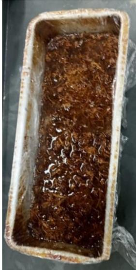
Com todos os procedimentos testados, o grupo começou a fazer o material de bioplástico com fibra de coco já em um molde em um formato que lhes seria adequado. Para um primeiro teste, utilizaram cápsulas de evaporação de porcelana. Os resultados não foram como o esperado, porque o plástico filme derreteu, o que fez a mistura escoar pela cápsula e não sair corretamente.
