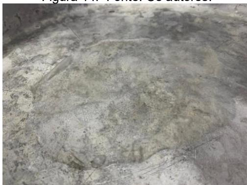
Percebendo que o procedimento escolhido não estava sendo favorável para os estudos do bioplástico, mudou-se a metodologia de produção para a de (BRESSANIN, 2010). A partir disso, produziu-se um bioplástico com a pesagem de 2,5g de amido comprado em uma balança analítica com auxílio de um béquer de 100mL e uma espátula de metal. Em seguida, adicionou-se 25mL de água, 3mL de HCl, 2mL de glicerina, sempre com agitação.
