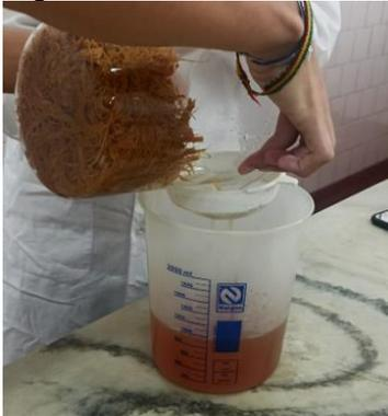
Por fim, lavou-se as fibras sob água corrente, com o apoio de uma peneira, a fim de abaixar sua alcalinidade e atingir o pH neutro. Em seguida, o material foi disposto em uma forma de alumínio e levado à estufa Estufa Solab CL-100 a 100°C por 24 horas. Após o tempo estipulado, o grupo triturou as fibras com amparo de liquidificador e tesoura para obtenção de partições menores. Por fim, pesou o conteúdo resultante, chegando a 15g de fibra.
