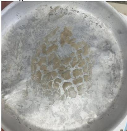
Com objetivo de conferir que o amido extraído poderia ser o problema, repetiu-se o processo de fabricação de (PEREIRA *et al.* 2017, *apud* DEL VECCHIO, 2023), porém com o amido comprado utilizado na execução da primeira amostra. Parte do conteúdo foi disposto em uma forma de aço e a outra em uma placa de Petri. O resultado se mostrou, novamente, insatisfatório. Sua coloração estava mais transparente, como o primeiro, entretanto ainda estava quebradiço, principalmente o da forma de aço.
