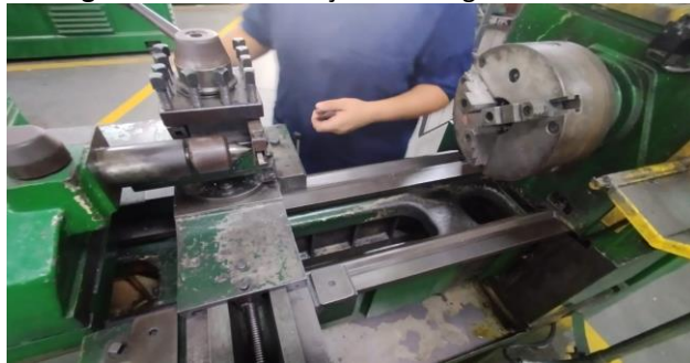
Figura 33: Transformação do tarugo em um tubo
