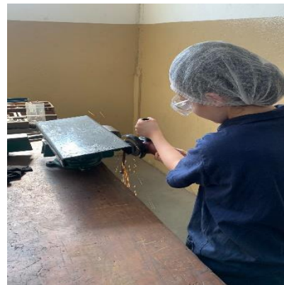
Figura 22: Retirada da tinta e sobra do material
