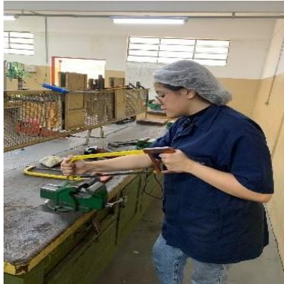
Figura 27: Processo de serra do tubo
